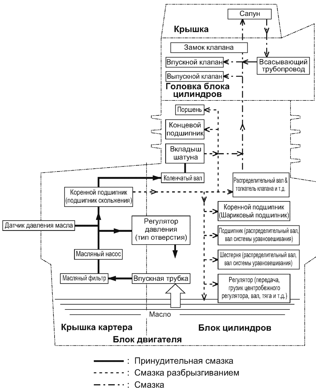
Рис. 76 Схема циркуляции масла
